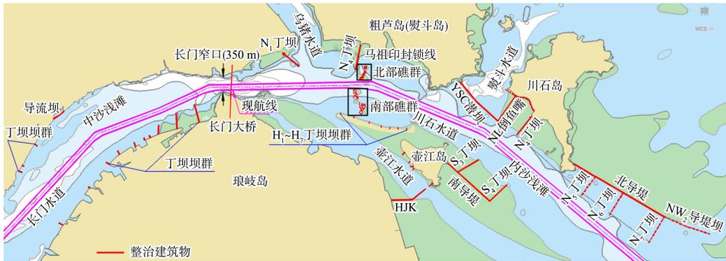
图3 马祖印、内沙、外沙航段整治建筑物
