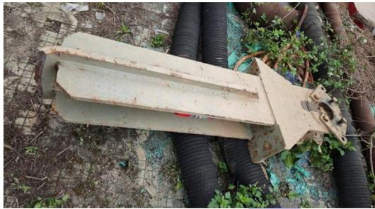
图 1 某 III 级船闸输水阀门折断的吊杆
