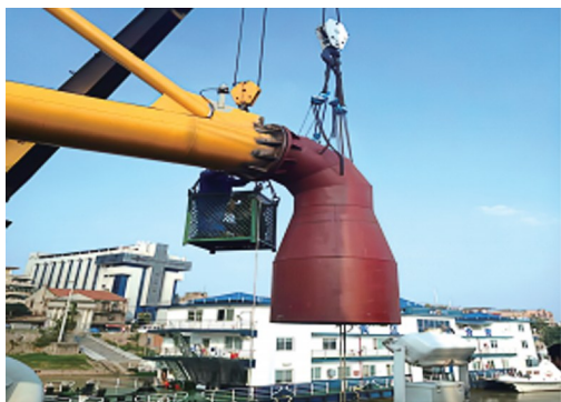
图 5 边喷管喷嘴改造
