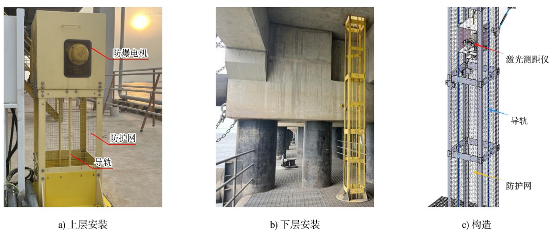
图 6 自动升降导轨式激光测距仪 Fig. 6 Laser rangefinder with automatic lifting guide rail
