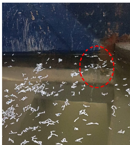
图 3 充水阀门双边开启时进水口附近流态
