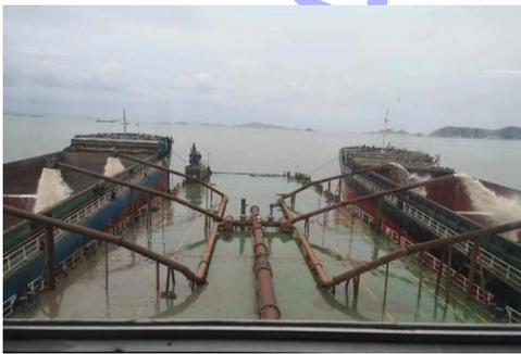
图 8 耙吸挖泥船装驳
