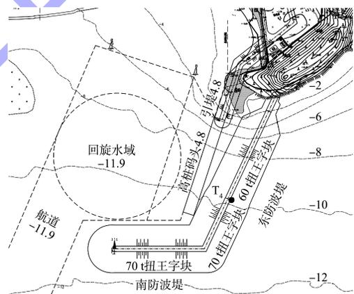
图 2 平面布置及波浪计算采样点分布 (单位: m)
