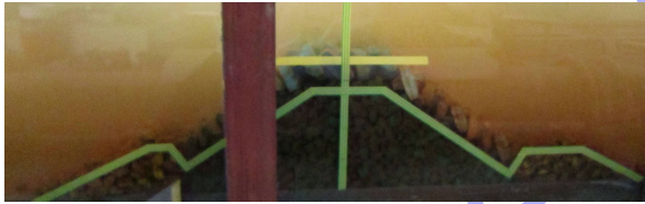
图 8 抛石加护面块体促淤堤
