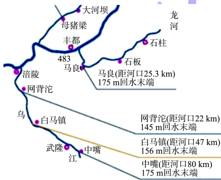
图 1 长江三峡库区涪陵段干、支流回水示意图
