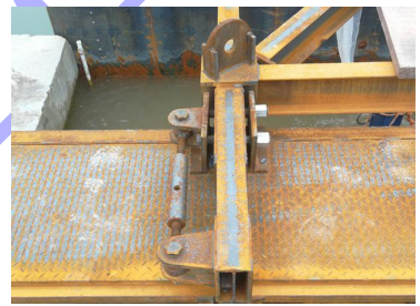
图4 组合式多功能吊具
