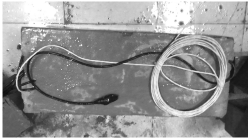
图 3 预埋有传感器的混凝土试件
