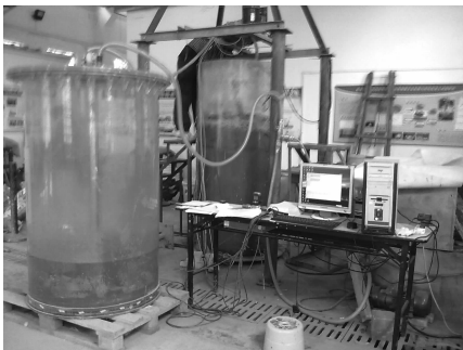
图 2 室内足尺单井模型试验装置
