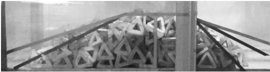
a) 外海侧坡度1:2；围堤内侧坡度1:1
