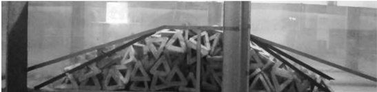
b) 外海侧坡度1:2；围堤内侧坡度1:1.5
