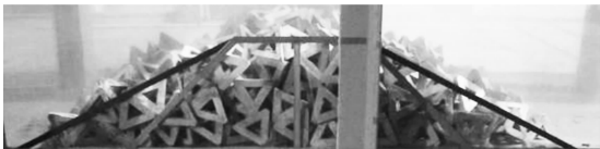
b) 外海侧坡度1:2；围堤内侧坡度1:2
