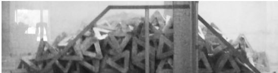
a) 外海侧坡度1:1；围堤内侧坡度1:1
