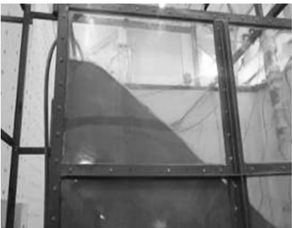
a) 边坡一侧加水
