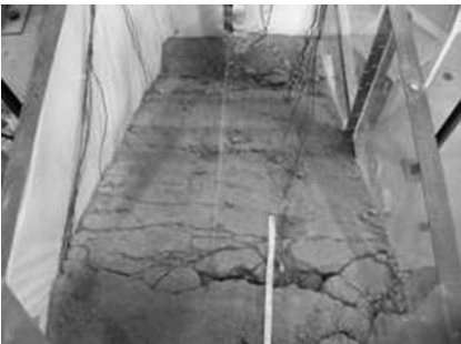
图 17 无水时边坡的渐进性破坏
