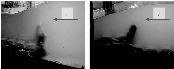
图 4 水流作用下压载块掀动（卷边）失稳状况
