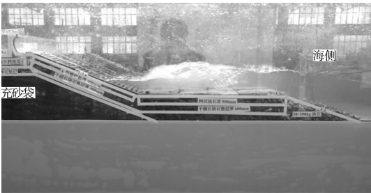
图 3 陡坡护岸波浪在戗台处破碎
