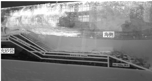
图 4 缓坡护岸波浪在胸墙附近破碎
