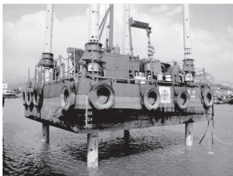
图2 海上液压升降钻探平台
