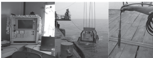
图6 海床CPTU设备及15 cm²的三桥电测探头
