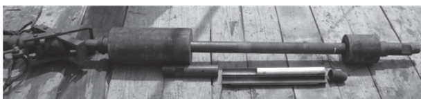
图7 标准贯入试验设备
