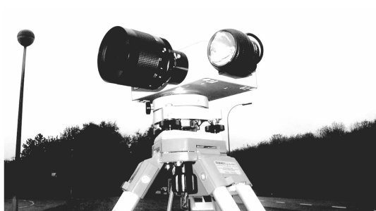
图 5 SIMBAT 激光测量系统
