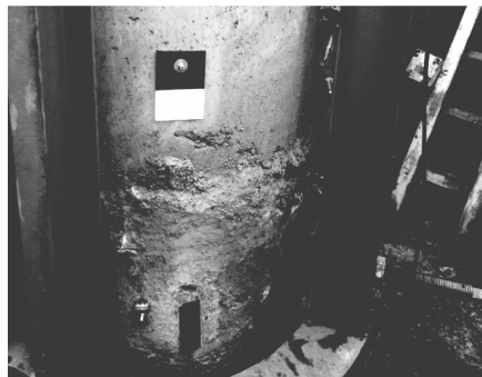
图 4 箔式电阻应变计、激光瞄准靶
