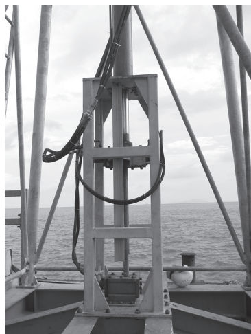
图4 水上静力触探试验实拍图
