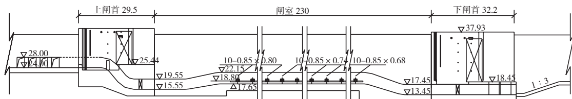
图1 分散输水系统布置(单位:m)
