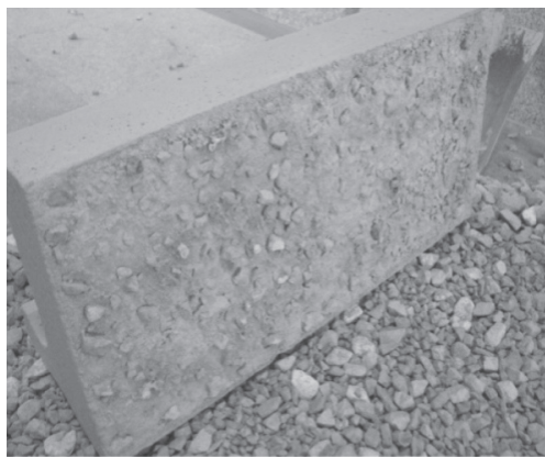
图3 模型胸墙底部加糙处理
