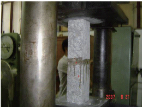
图1 大管桩接缝抗冻试件B-JF制作
