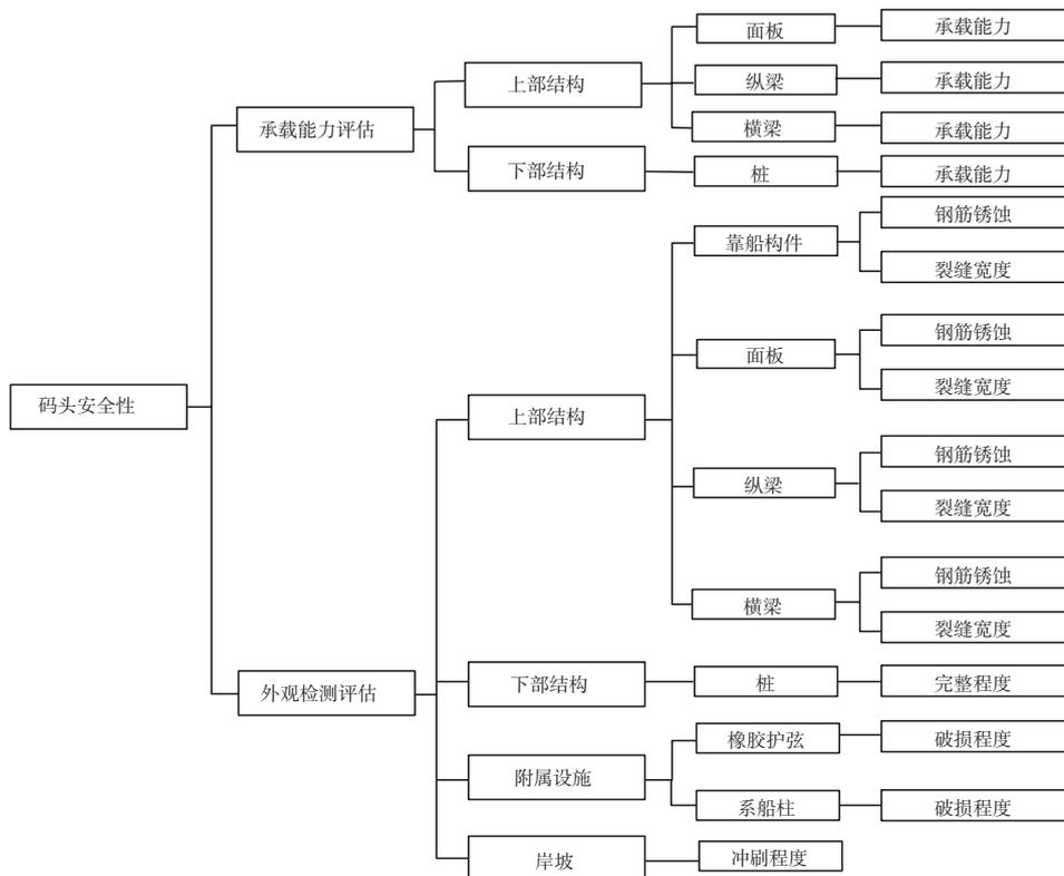
图1 高桩码头结构安全性评估指标体系
