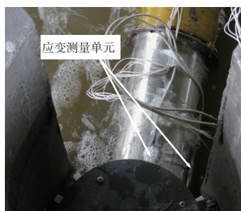
图10 应变测量单元布置实物图
