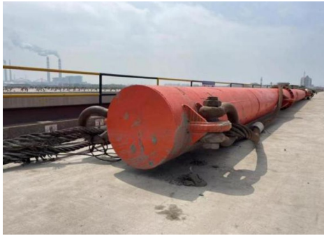
图 7 通用吊架 Fig. 7 Universal beam
