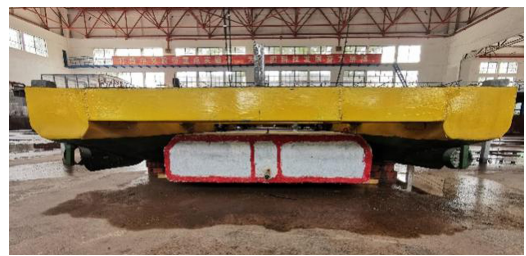
图4 一体船与管节物理模型
