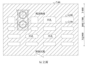
图 2 开孔沉箱方案结构(高程:m;尺寸:mm)
