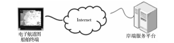
图 4 长江电子航道图船舶终端系统与岸端数据传输链路
