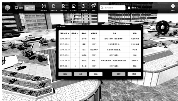
图 11 三维交互式船闸监控运维系统
