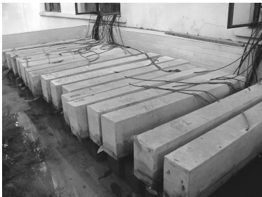
图 2 试件加速腐蚀
