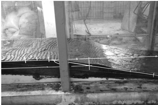
图5 滩面水深3 m、潮流速0.4 m/s、年均风浪, 航槽边坡1:5时泥沙淤积状况
