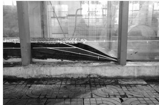
图6 滩面水深8 m、潮流速0.4 m/s、2 a一遇风浪, 航槽边坡1:3时泥沙淤积状况
