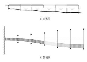
图5 多跨栈桥梁面变形
