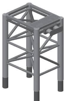
图5 透空式钢管桁架主体结构
