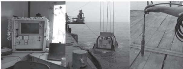
图6 海床CPTU设备及15 cm 2 的三桥电测探头
