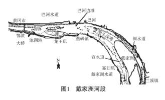
天然边界条件下,由于年内、年际间来水来沙的变化,上游顺直段深泓左、右摆动,导致过渡段两侧边滩消长不定,在深泓左、右摆动变化中或消长或发育,如窑监水道进口新河口边滩和洋沟子边滩、马家嘴水道进口白渭洲边滩以及雷家洲边滩(图2)等。当深泓左摆时,右侧处在缓
