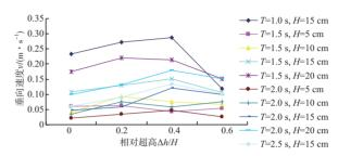
图5 波浪作用下结构物底面水质点的最大垂向运动速度 与超高的关系(d=50cm)
