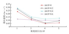
图6 规则波作用下结构物底面水质点的最大垂向运动速 度与结构相对宽度的关系(d=50 cm)
