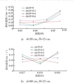
图4 波浪作用下结构物底面水质点的最大垂向运动速度 与波陡的关系
