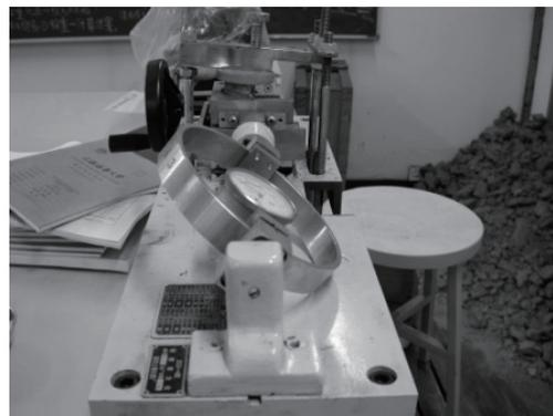
图2 半模直剪试验仪
