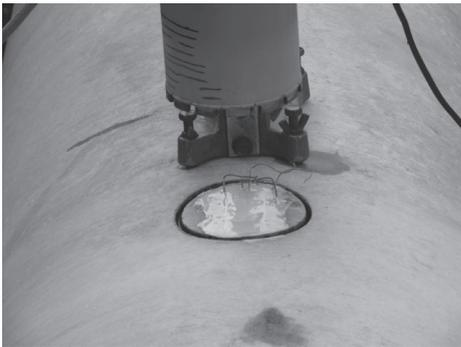
图5 钻孔及应变片布置
