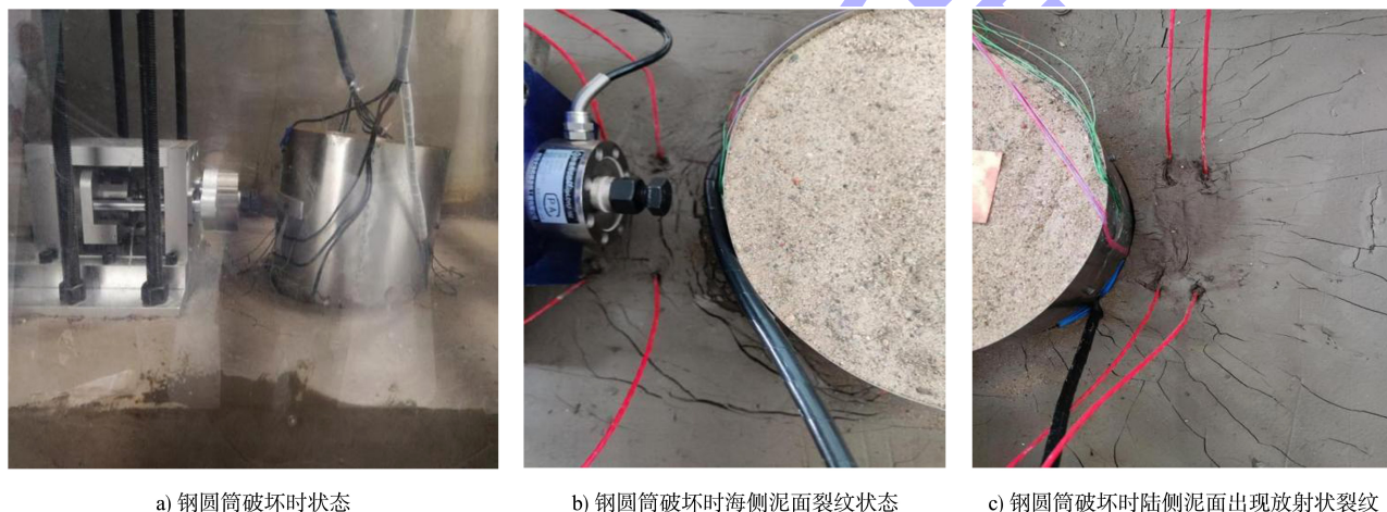
图 7 钢圆筒失稳破坏时的现象
