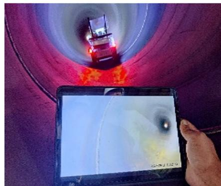
图7 桩检机器人检测作业
