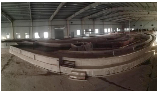
图 3 隧洞式引航道 1:36 物理模型 Fig. 3 1:36 physical model of tunnel type of approach channel
