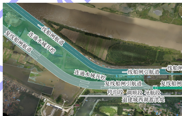
图 4 常规复线船闸引航道布置
