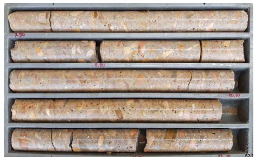
图 9 1950 年方块混凝土结构取样
