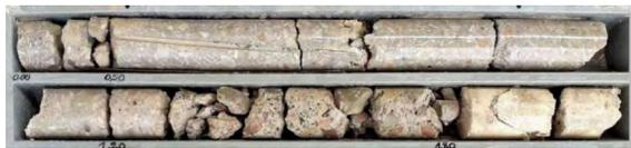
图 11 1968 年胸墙钢筋混凝土结构取样
