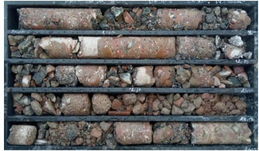
图 8 1928 年方块混凝土结构碎裂部分取样
