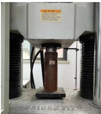
图4 灌浆材料模型加载装置
