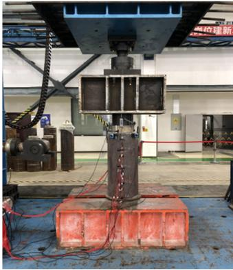
图2 桩芯与钢管灌浆料模型加载装置
