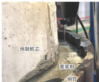
图 5 预制桩芯与钢管灌浆连接测试
