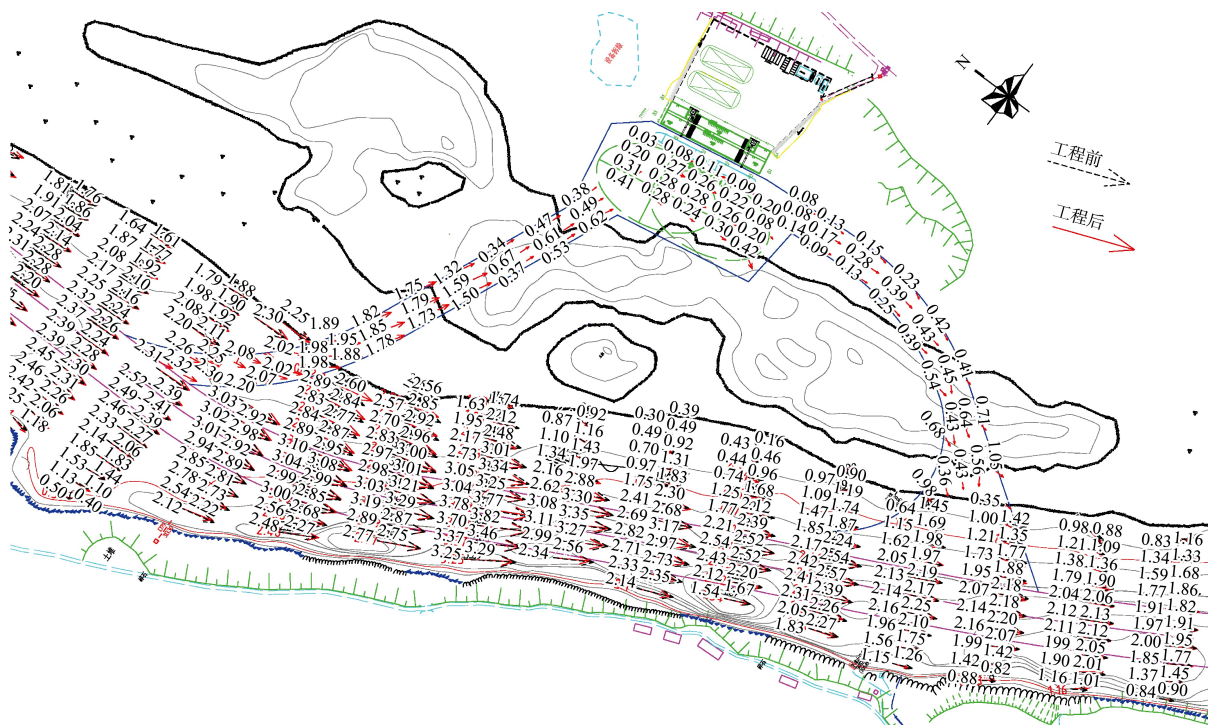
图4 Q = 1900 \text{ m}^3/\text{s} 工程前后流场对比
