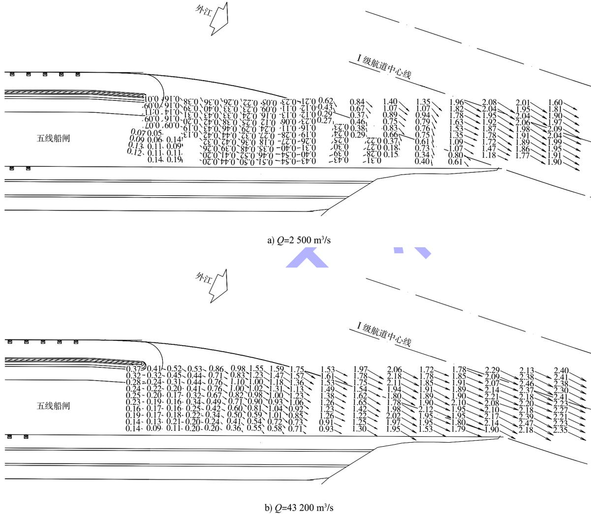
图 3 五线船闸下引航道口门区流速分布 (设计方案) (单位: m/s)
