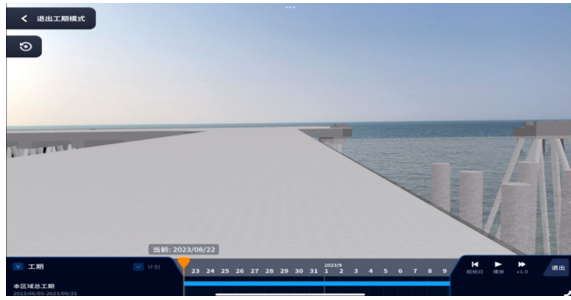
图 10 工作平台施工进度管控
