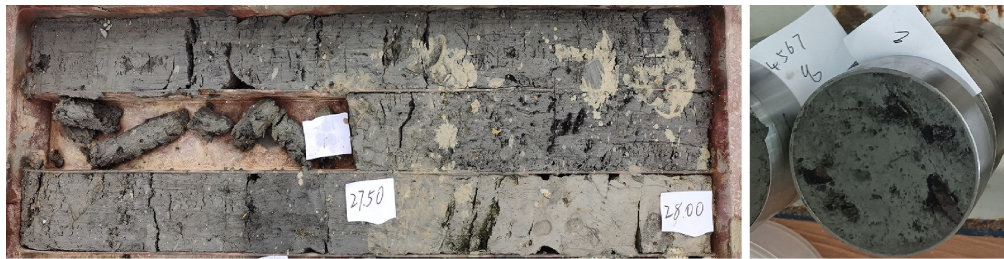
图4 下层软土含腐木碎剖面
