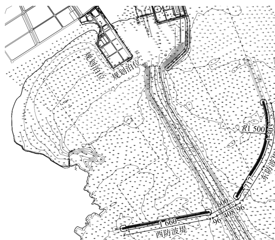
图1 防波堤平面布置(单位: m)
