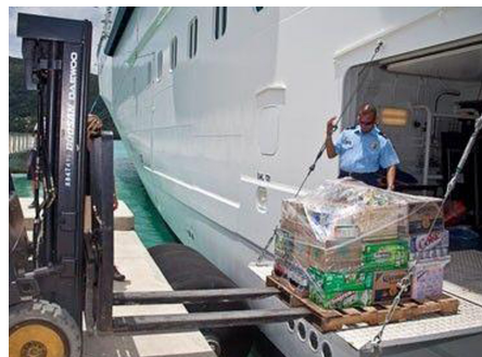
图6 行李舱口位于码头面以上装卸作业
